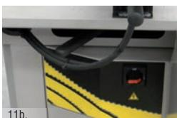
b. Comoda posizione frontale della leva di blocco / sblocco dell'arco per i tagli inclinati.
