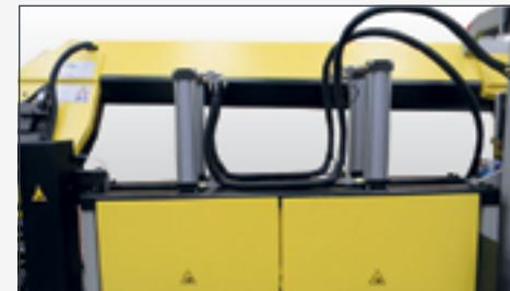
Cilindri pneumatici verticali per il bloccaggio del pezzo.
