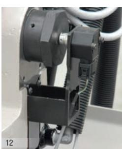
Sensore posizione arco. Ad ogni avvio, la macchina memorizza la posizione di partenza dell'arco. A fine ciclo, l'arco ritorna automaticamente alla quota di partenza. Questo permette all'operatore di risparmiare tempo quando i pezzi da tagliare hanno le stesse dimensioni.
