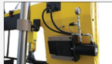
Tenditore idraulico e sensore rotazione lama.
