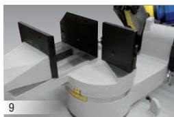
Avvicinamento della ganascia mobile tramite una vite trapezoidale che garantisce un sistema di manovra scorrevole ed efficiente anche ad elevati carichi.
