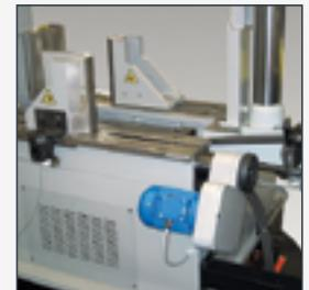
**MAO3:** Motorizzazione elettrica del riscontro per tagli da -45° a 45°. *Stop electric motorization for cutting from -45° to 45°.*
