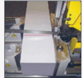
**MAO2:** Motorizzazione elettrica del riscontro per tagli da 0° a 45°. *Stop electric motorization for cutting from 0° to 45°.*
