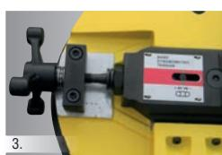
La lama è tensionabile manualmente. Un sistema dinamometrico segnala la giusta tensione della lama. Il raggiungimento della tensione corretta è chiaramente visibile da una tacca, in caso di rottura della lama, un finecorsa ne interrompe la rotazione.
