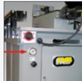
**RPM2:** Regolatore pressione morsa aggiuntiva, adatta per taglio di materiali di spessore sottile. *Additional vice pressure regulator for thin thickness materials.*
