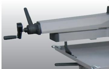
Solda morsa in ghisa con avvicinamento manuale e bloccaggio rapido del pezzo a leva.
