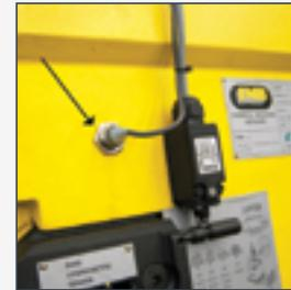
**TM:** Tastatore meccanico di avvicinamento rapido al materiale. *Mechanical fast approach device.*
