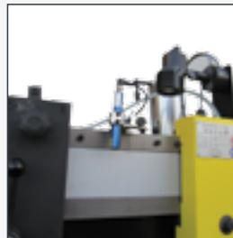
**M2:** Morsa aggiuntiva per il bloccaggio del materiale in lato scarico. *Additional workpiece locking vice on unloading side.*
