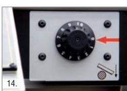
Sistema di movimentazione arco con cilindro idraulico e valvola di flusso monogiro per regolazione discesa in posizione frontale.
